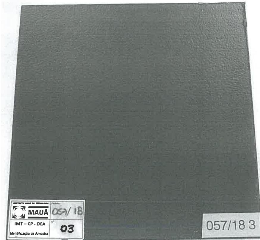
Figura 12: Amostra 03 após 240 horas de exposição em névoa salina
