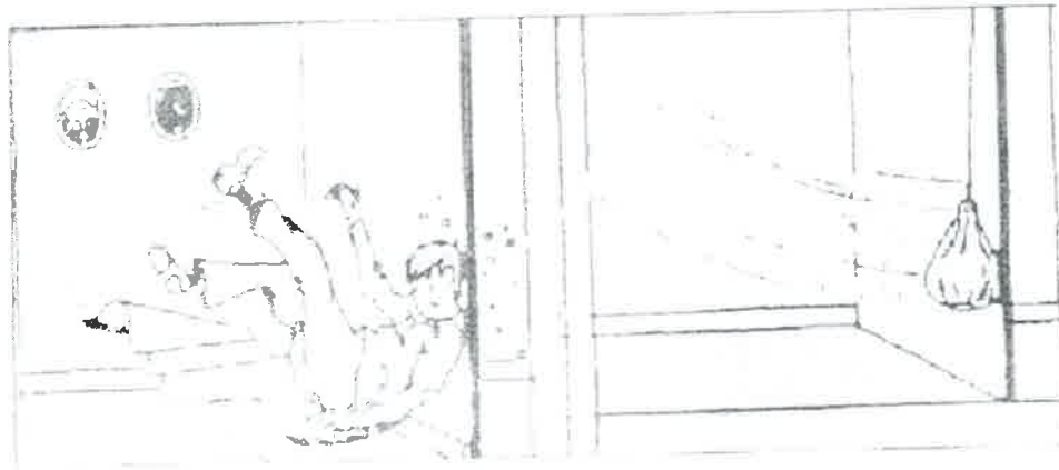
Figura 3.2 - Representação do ensaio do corpo mole
