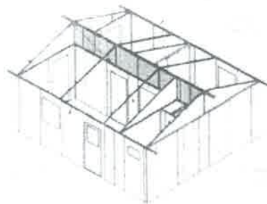
Figura 2.22 - Vista geral da passagem de fiação no sistema CASA MODULAR FISCHER. Fonte: Immas Fischer S.A.
