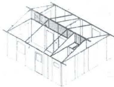
Figura 2.22 Vista geral da passagem de fiação no sistema CASA MODULAR FISCHER. Fonte: Immaos Fischer S.A.
