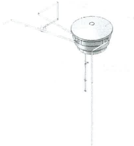
Figura 2.23 - Vista geral da distribuição de água fria no sistema CASA MODULAR FISCHER. Fonte: Irmãos Fischer S.A.
