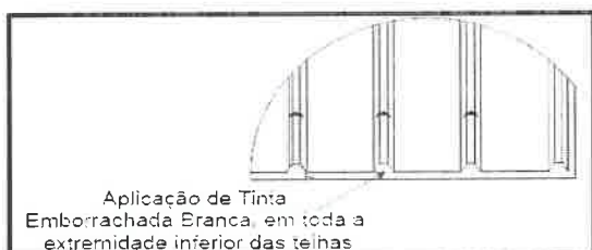
Figura 38 – Local de aplicação da tinta emborrachada
